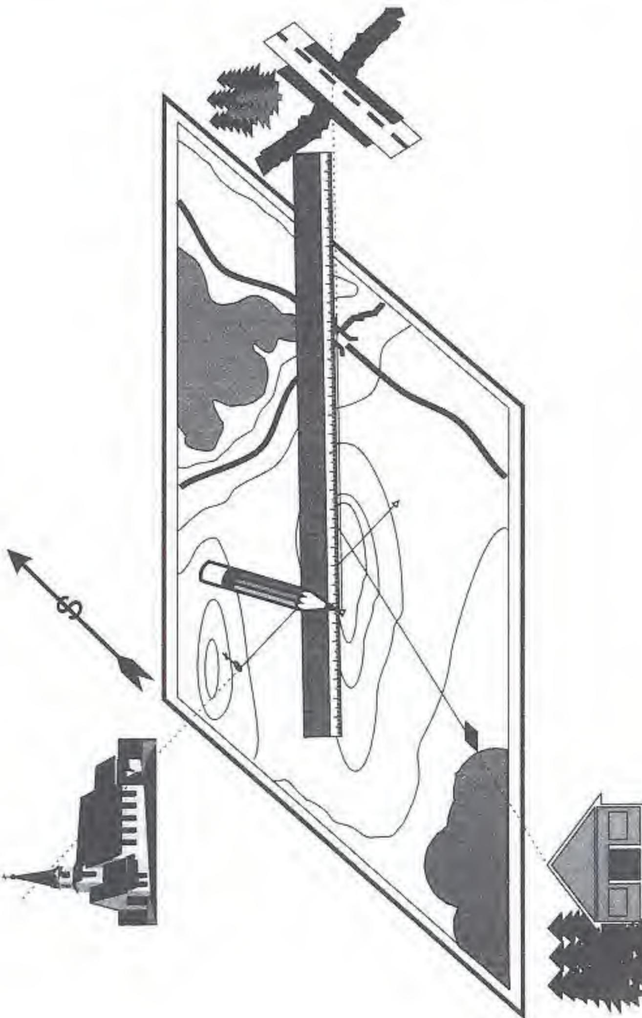
Слика 65. Одређивање места осматрачице по карти оценом одока пресека њем уназад
